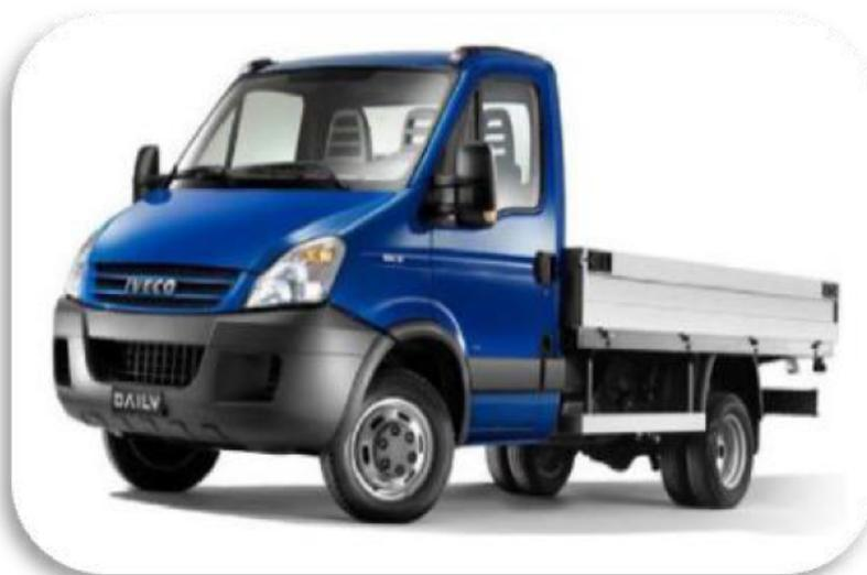
**Autocarro a pianale con pedana, atto alla raccolta e al trasporto verso i centri comunali di raccolta degli ingombranti e RAEE, capacità 3,5 tonnellate**
